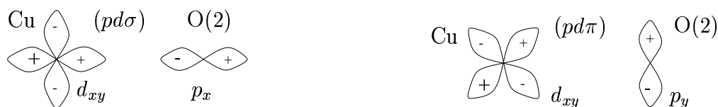
FIG. 4.4 – Définition des intégrales de saut (pd\sigma) (l'intégrale est donnée par l'équation (4.8)) et (pd\pi) (équation (4.9)). Les valeurs en eV données par les calculs de structure de bandes sont (pd\sigma) = -1.2\text{eV} et (pd\pi) = 0.5\text{eV} .
